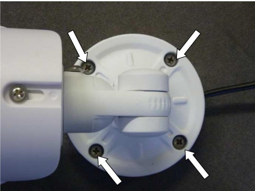
**<底部取り付け金属プレートの分離>**
